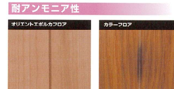
耐アンモニア試験：濃度100ppmアンモニア液下注、24時間放置
