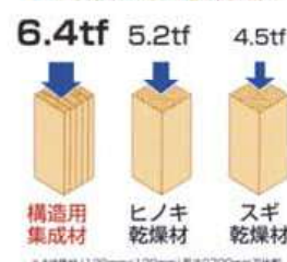
柱材の長期許容圧縮力比較
